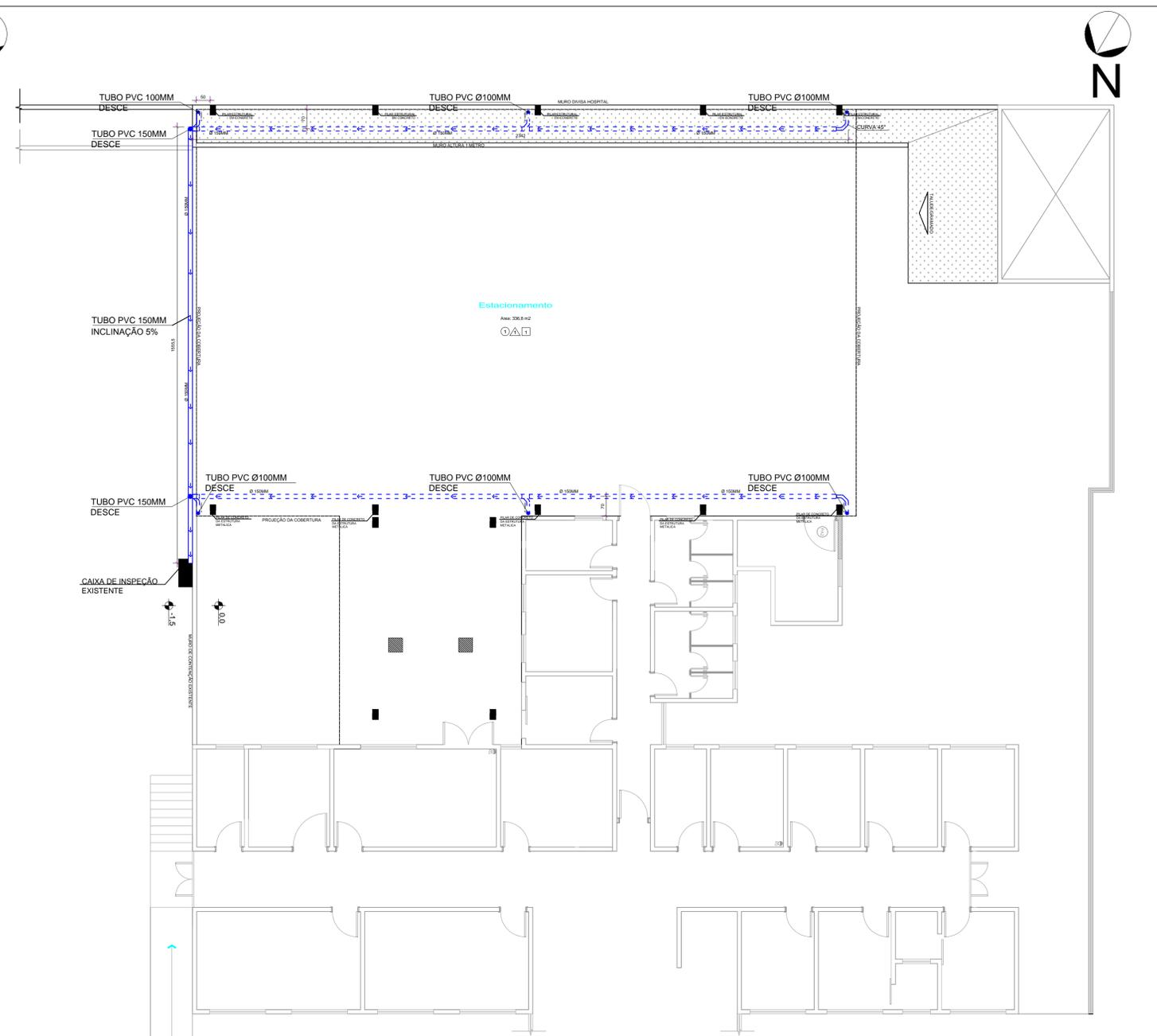
↑ PLANTA HIDRÁULICA ÁGUAS PLUVIAIS
